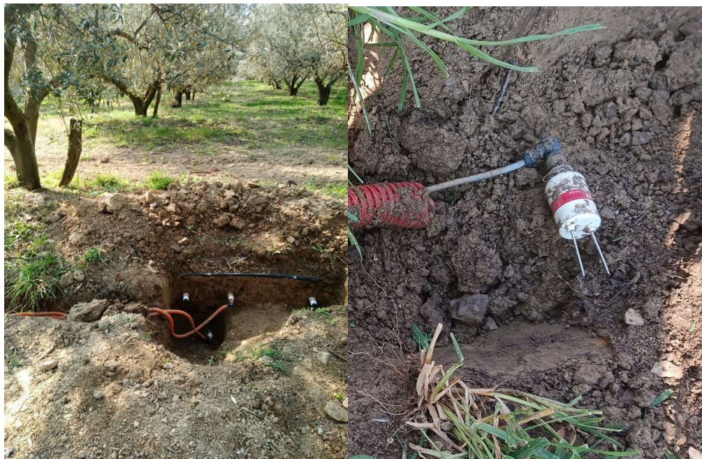
Slika 2: Namestitev TDR sond pod namakalno cevjo (levo) in TDR sonda (desno)
